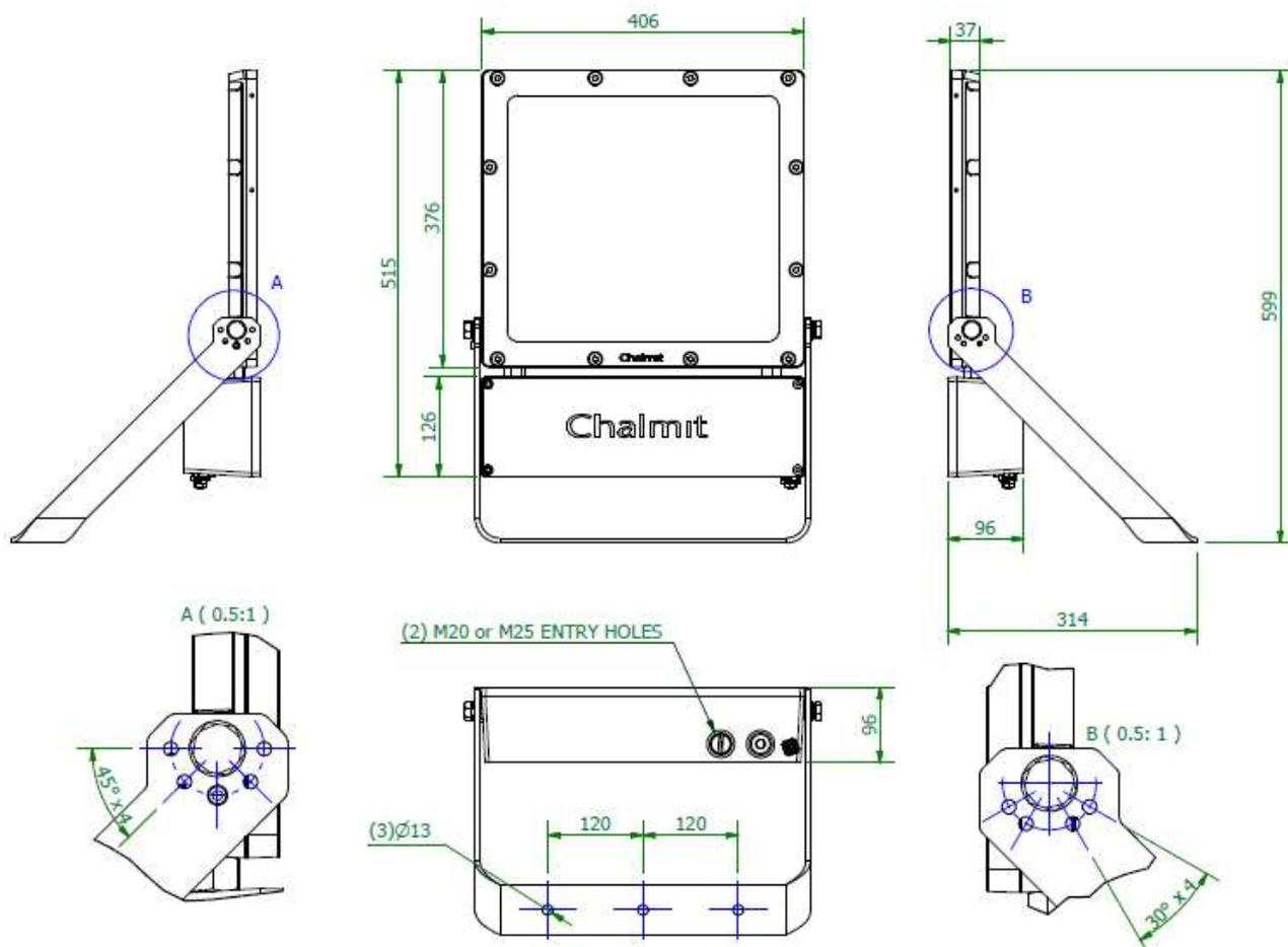
КРОНШТЕЙН-СКОБА ПРОЖЕКТОРА EVOLUTION X СОДЕРЖИТ ЗАРАНЕЕ ПОДГОТОВЛЕННЫЕ УГЛЫ ФИКСАЦИИ, ПОЗВОЛЯЮЩИЕ МЕНЯТЬ НАПРАВЛЕНИЕ ПРОЖЕКТОРА С ШАГОМ В 30° ИЛИ 45°. СМ. ЧЕРТЕЖ ВЫШЕ.
